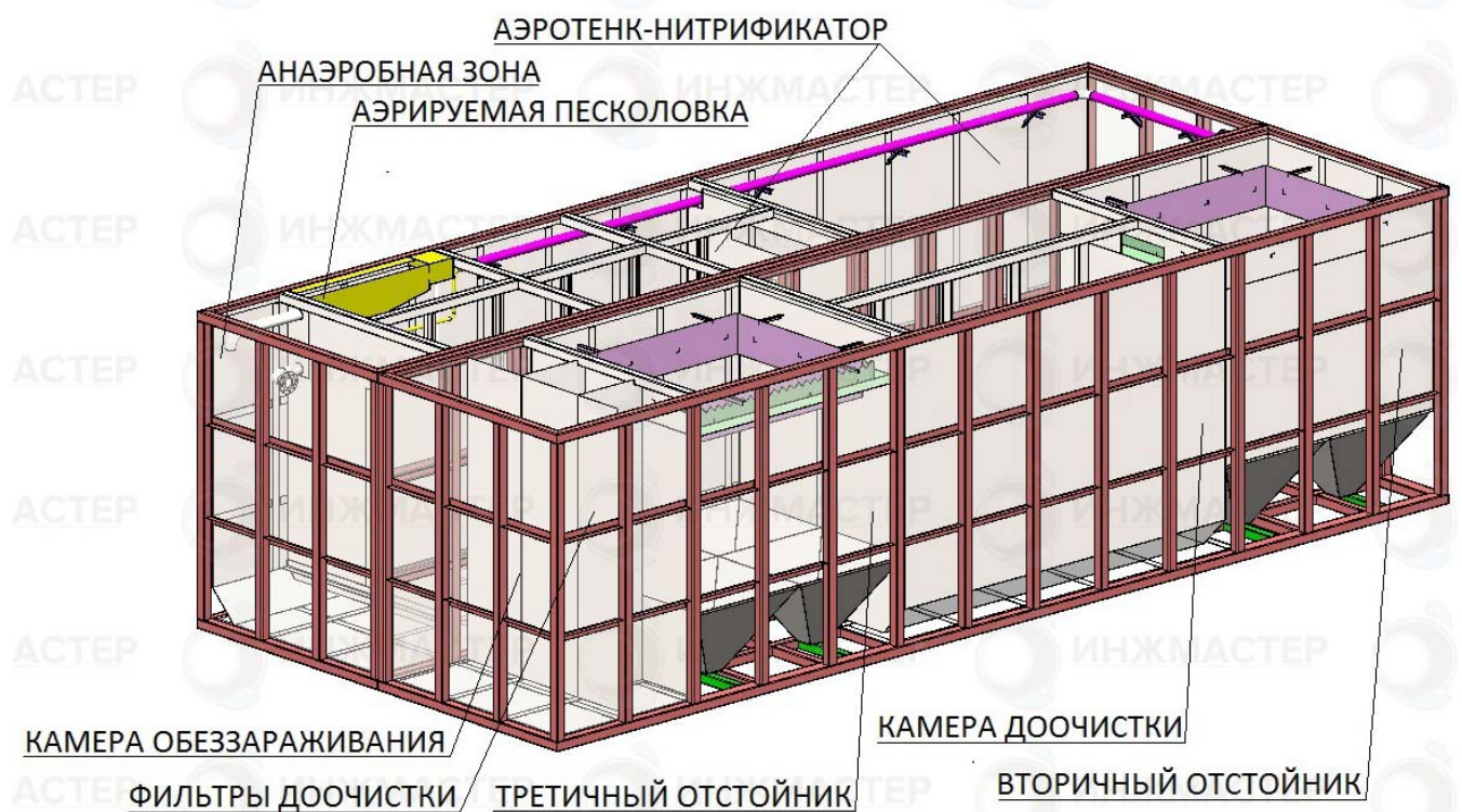
Рисунок 4.2 – Строение блочных очистных сооружений
